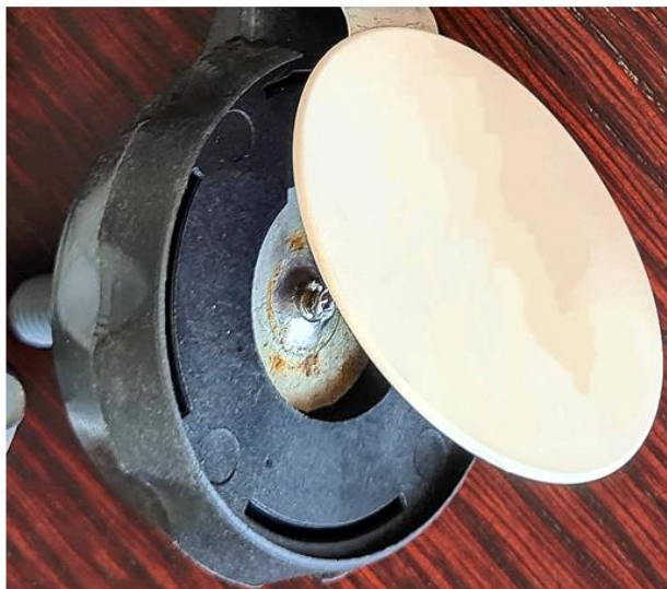
Ogniska korozji w nowym ograniczniku wyjętym z pudełka
