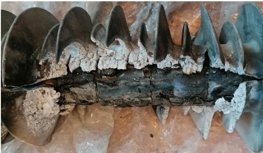
Uszkodzony ogranicznik – przyczyna: wada fabryczna
