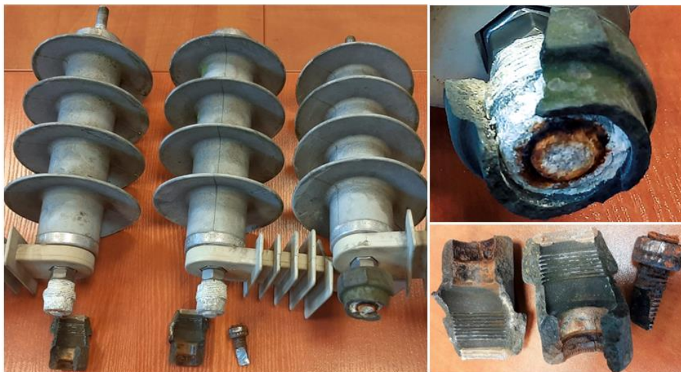
Uszkodzony ogranicznik (odłącznik) – przyczyna: nieprawidłowy montaż
