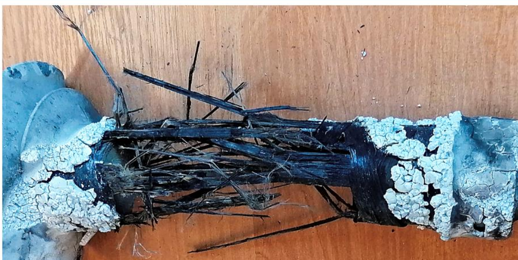
Uszkodzony ogranicznik – przyczyna: wada fabryczna
