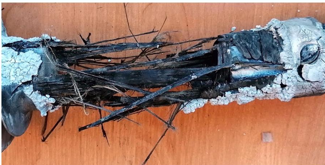
Uszkodzony ogranicznik – przyczyna: wada fabryczna
