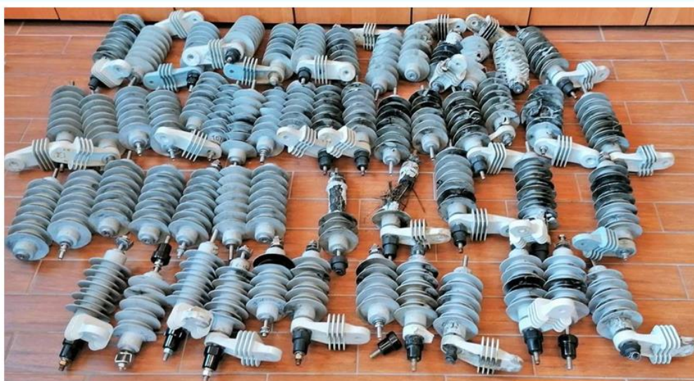
Uszkodzony ogranicznik – przyczyna: wada fabryczna
