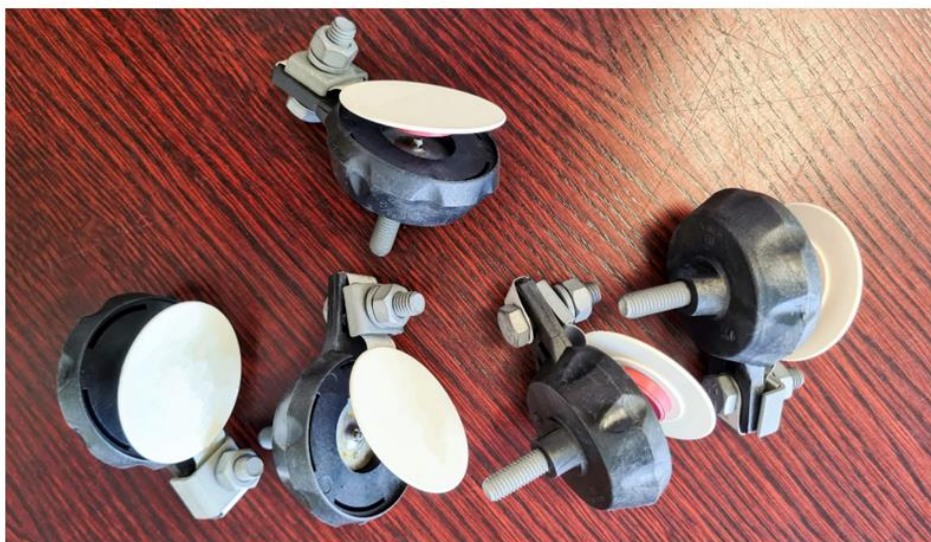
Uszkodzony ogranicznik – przyczyna: wada fabryczna
