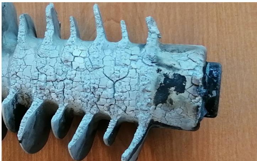
Uszkodzony ogranicznik – przyczyna: wada fabryczna
